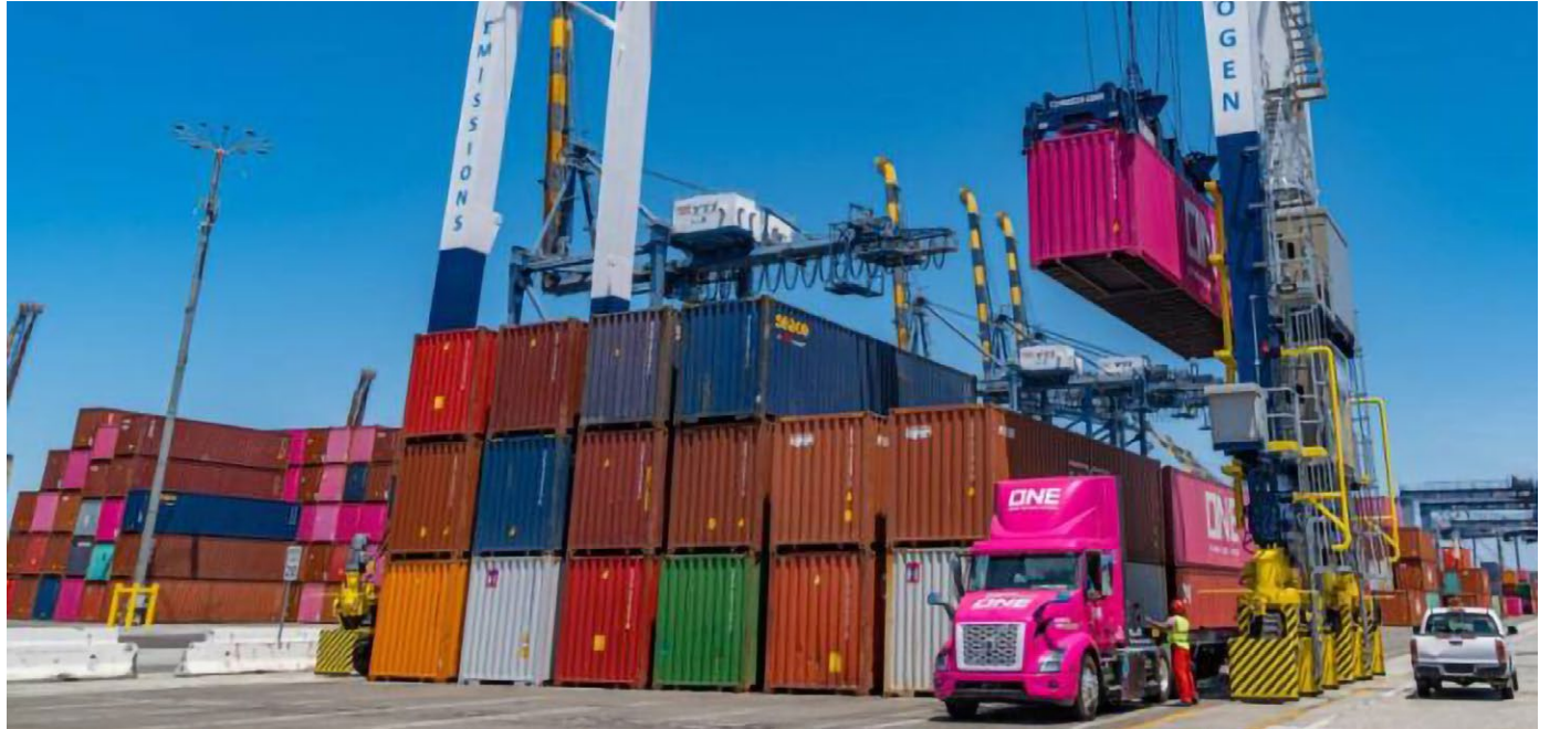
La grúa H2-ZE RTG Transtainer de Paceco, desarrollada en colaboración con Mitsui E&S, comenzó a operar en Yusen Terminals. Es la primera grúa de patio RTG impulsada por pilas de combustible de hidrógeno que opera en esta terminal en el Puerto de Los Ángeles. Paceco's H2-ZE RTG Transtainer crane, developed in collaboration with Mitsui E&S, began operations at Yusen Terminals. It is the first hydrogen fuel cell-powered RTG yard crane to operate at this terminal at the Port of Los Angeles.
