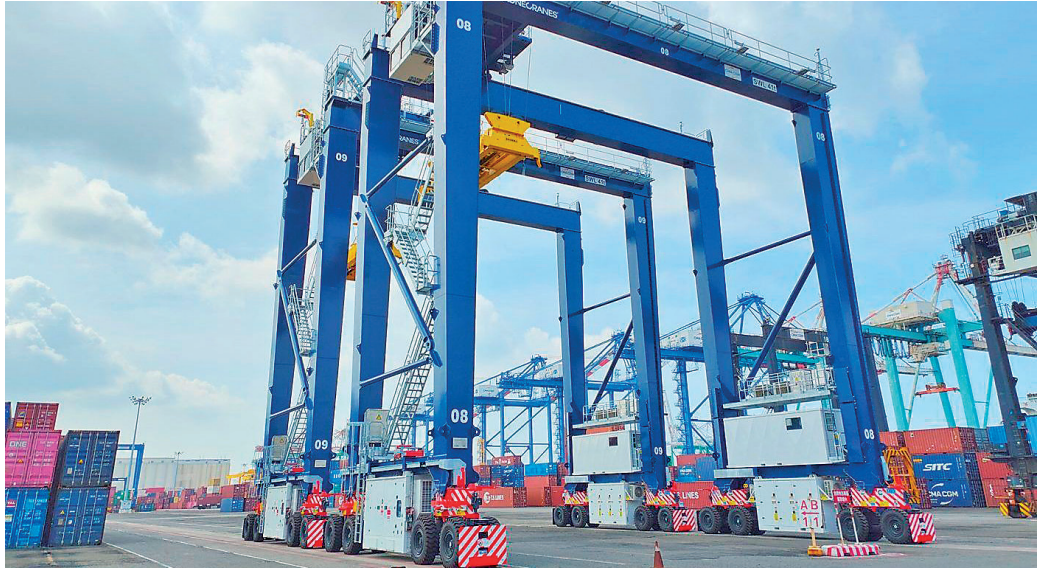
La terminal de CSP de Valencia ha adquirido seis nuevas grúas híbridas RTG para reducir sus emisiones. / The Valencia CSP terminal has acquired six new RTG hybrid cranes to reduce its emissions.
